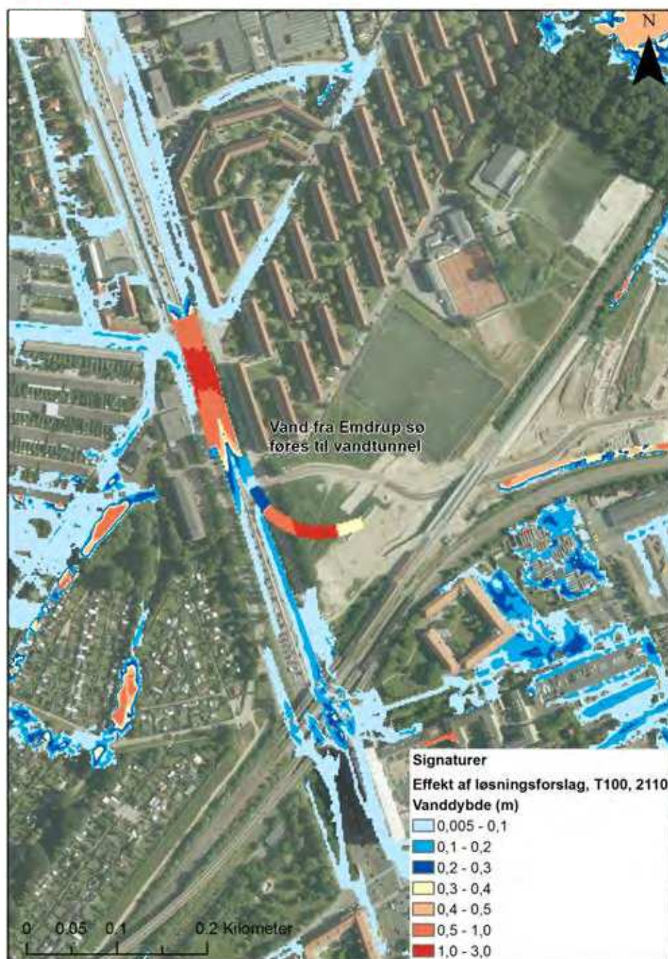
Figur 5-19 Oversvømmelser ved Lyngbyvej/Helsingørmotorvejen efter tiltag for 100 års regnhændelse i 2110. Grunden til oversvømmelserne er at Lyngbyvejs, Helsingørmotorvejens og Nordhavnsvejs afvandingsystemer er dimensionerede til mindre end 100 års regnhændelse.
