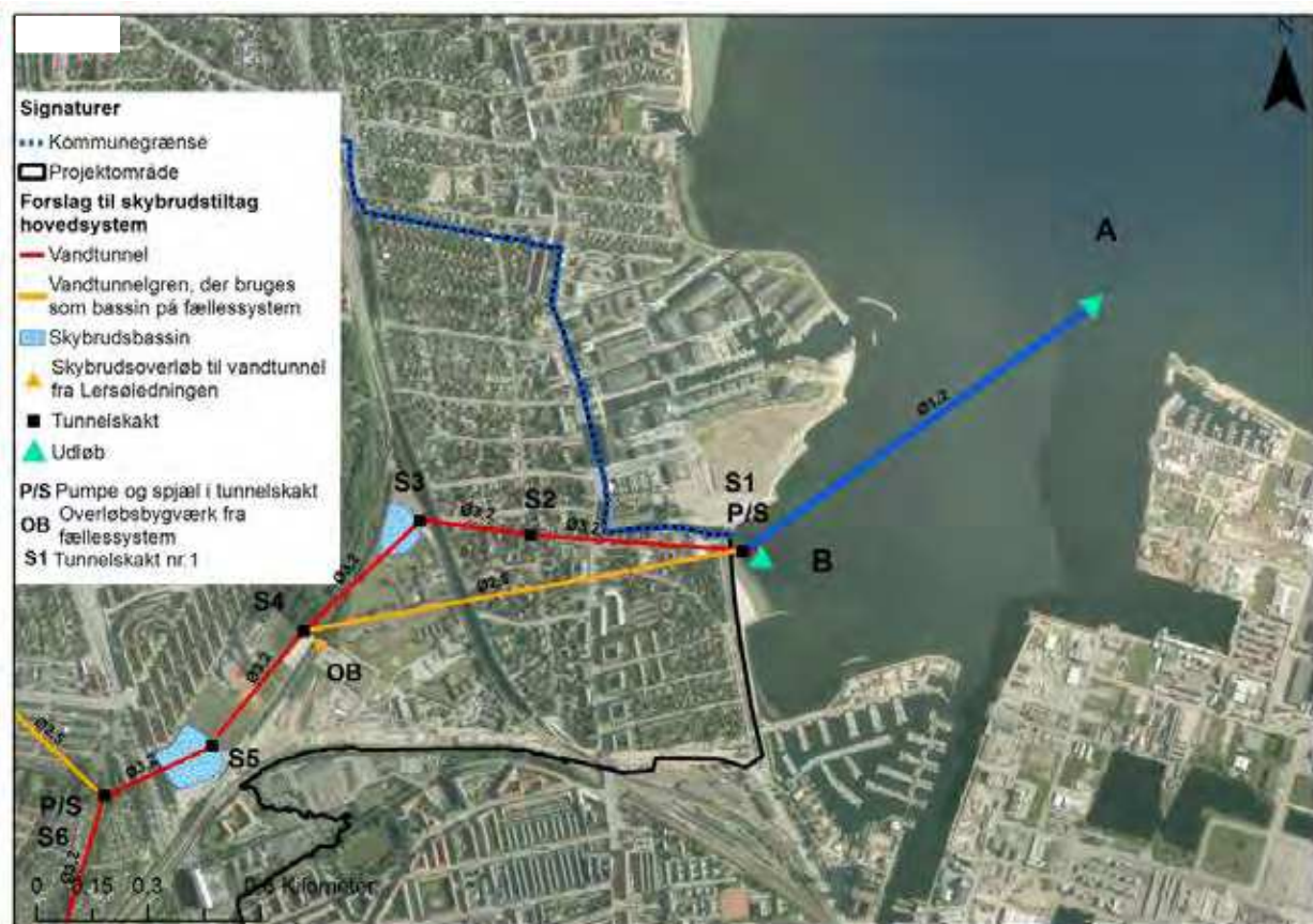
Figur 5-17 Nye Udløb A og B fra vandtunnel i Svanemøllebugten. Alternativ placering af vandtunnels udløbsarrangement i Københavns Kommune.
