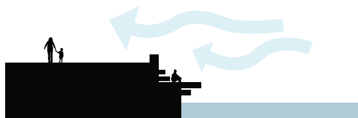
2.7 Kajkant som vindbryder
