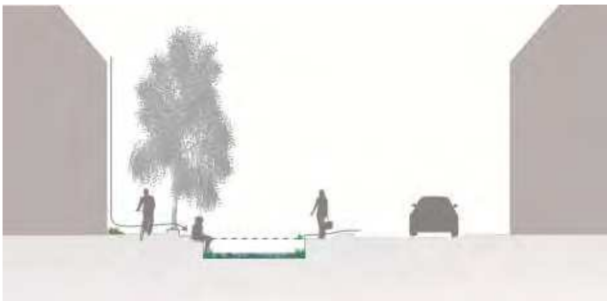
Figur 6.1. Tværsnit af typisk kanal-løsning (> 4 meter bred). Den blå stiplede linje angiver højden som vandet kan stige til i skybrudssituationen. Skitse: Gruppe F
