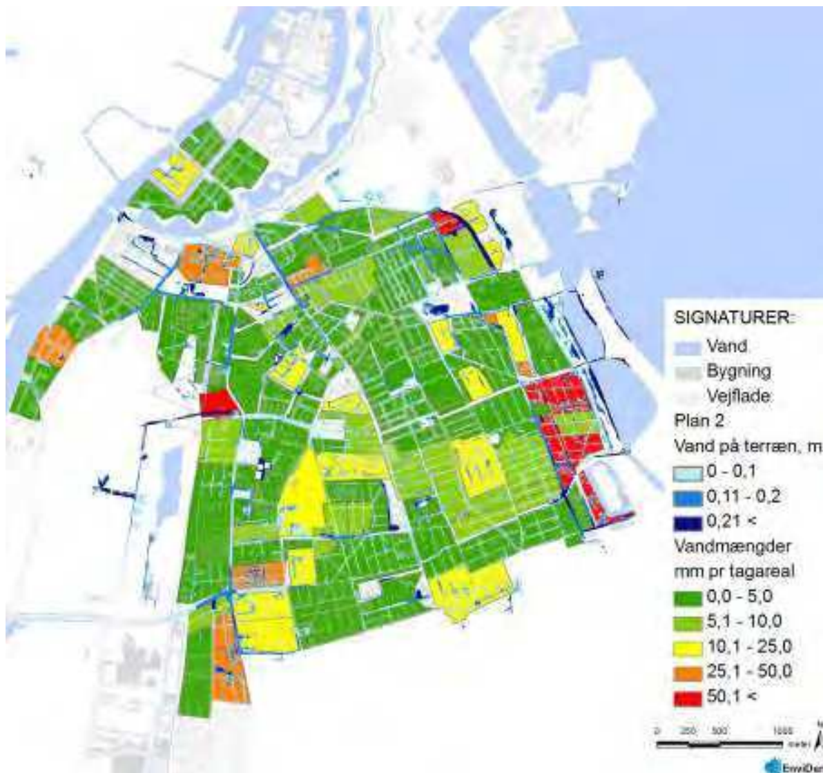
Figur 5.6: Vandmængder jf. fig. 5.5 omregnet til mm vand pr. tagareal, indenfor de enkelte områder. Kortbilag T04.10 kombinerer figur 5.5 og 5.6.
