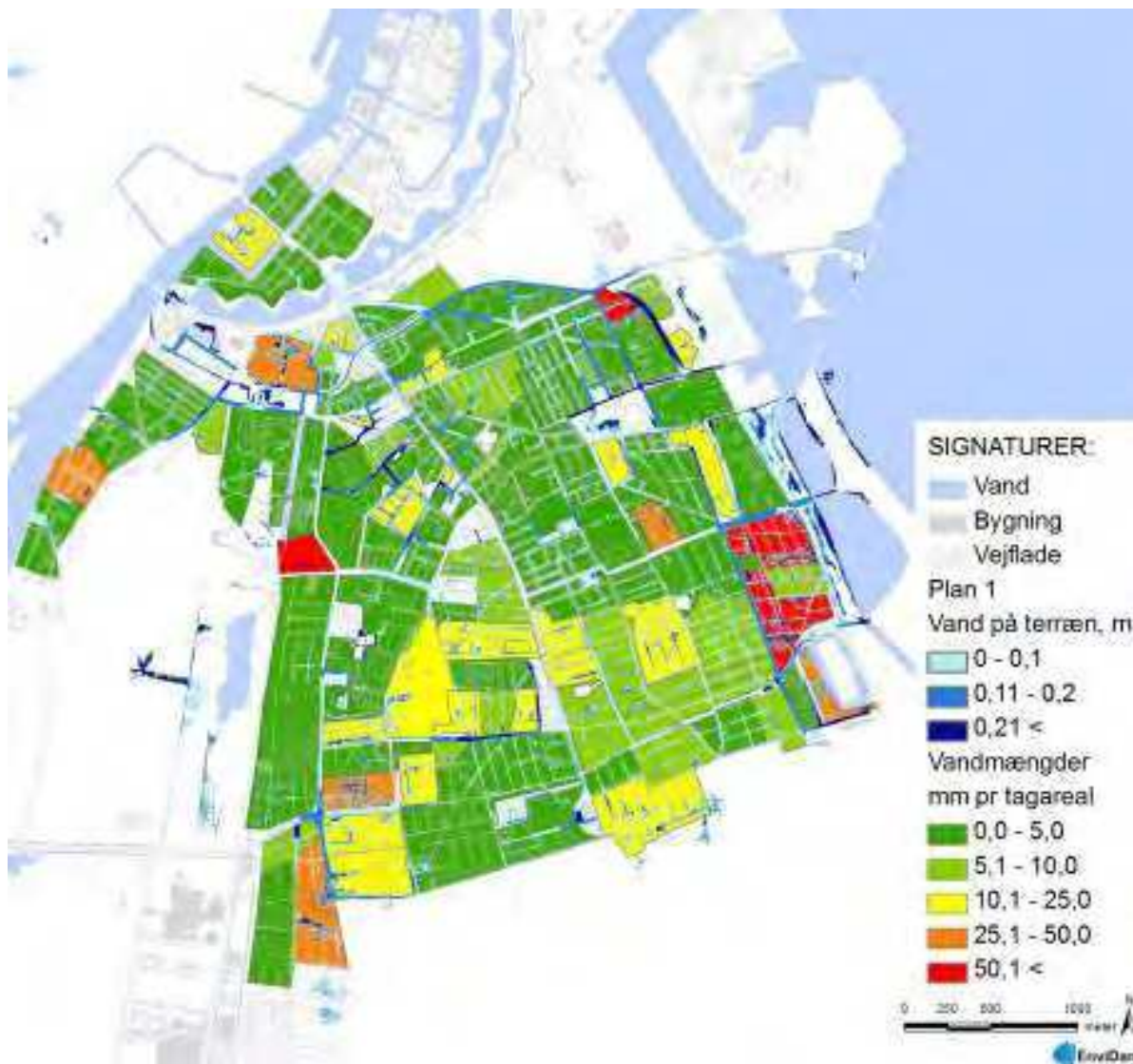
Figur 5.3: Vandmængder jf. fig. 5.2 omregnet til mm vand pr. tagareal, indenfor de enkelte områder. Kortbilag T04.09 kombinerer figur 5.2 og 5.3.
