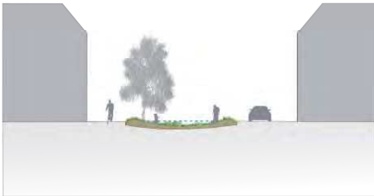
Figur 6.3. Tværsnit af typisk grønt parkstrøg (> 4 meter bred) med kapacitet til at håndtere skybrudsvand. Den blå stiplede linje angiver højden som vandet kan stige til i skybrudssituationen. Skitse: Gruppe F
