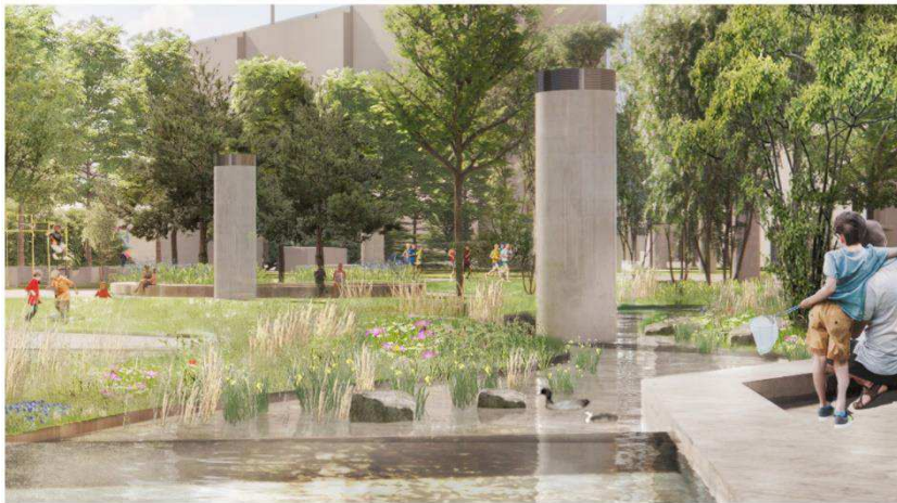
Figur 6: I visionsoplægget for Bispeengbuen pumper en del af vandet op fra Ladegårdsåen, til overfladen og falder ned igennem en række forbundne bassiner.
