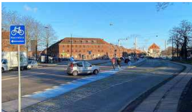
Cykelsti mellem ligeud og -højresvingsbane, Hillerødgade/ Borups Allé
