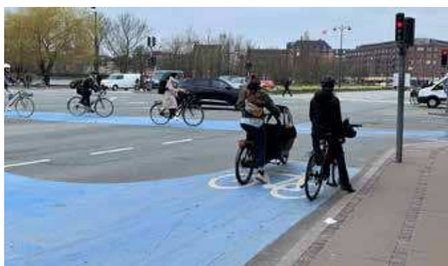
Venteområde til venstresvingende cyklister med blåt cykelfelt, Gyldenløvesgade/Nørre Søgade
