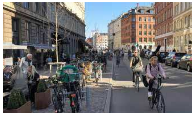
Cykelgade med fortovsudvidelse, træer og cykelparkering på Vendersgade
