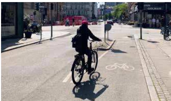
Slipseløsning med midterhelle på Studiestræde
