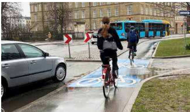
Blåt cykelfelt hvor højresvingsbanen krydser cykelstien uventet på Nørre Voldgade
