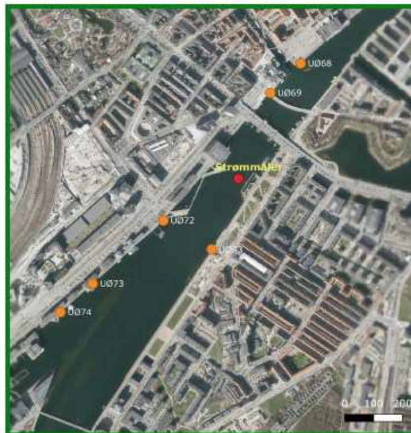
Figur 2-1 Udløb fra overløbsbygværker omkring Havnebadet Islands Brygge.
