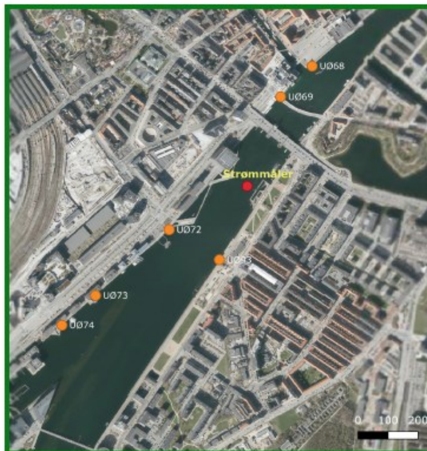
Figur 2-1 Udløb fra overløbsbygværker omkring Havnebadet Islands Brygge.
