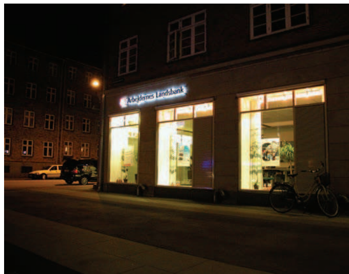
Skiltebelysning med coroneffekt (bogstaver, der er belyst bagfra) løser på fin måde eventuelle blændingsproblemer.
