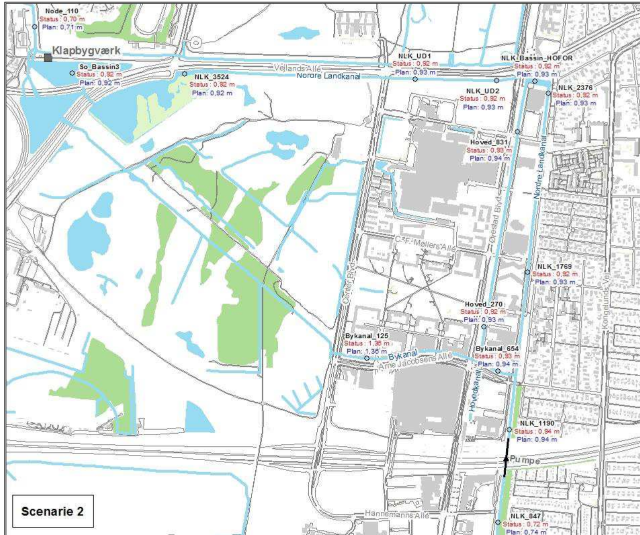
Figur 11 Oversigtskort med angivelse af maksimal vandspejlskote i Nordre Landkanal (fra E20 til udløb i havnen) for statussituationen (nuværende forhold) og plansituationen (når Bellakvarter er udbygget) for en 5-års regn med sikkerhedsfaktor 1,38. Koten for status er angivet med rødt og plan med blåt . Resultaterne er udført for scenarie 2, hvor vandstand i havn er i kote 0,7 m og 0,0 m i Nordre Landkanal.
