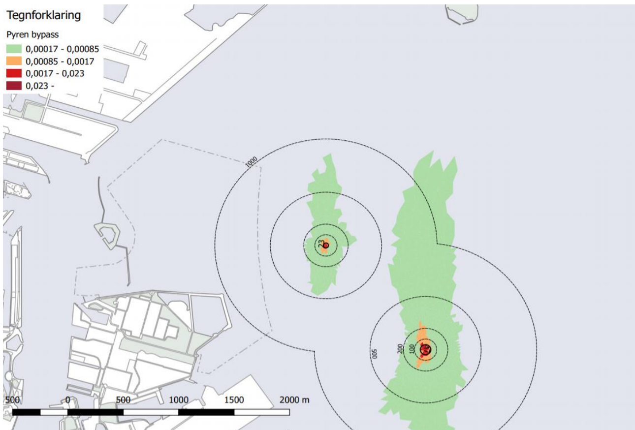
Figur 7.5: Den maksimale blandingszone for Pyren som udledes med bypass vandet. Udledning af bypass uden at der sker udledning af rensset vand, er udelukkende en teoretisk situation. Den nordligste af de to blandingszoner repræsenterer Renseanlæg Lynetten mens den sydlige blandingszone repræsenterer Renseanlæg Damhusåen. * Der vil ikke være situationer, hvor der udelukkende udledes bypass. I tilfælde af bypass-hændelser, vil bypassvandet udledes sammen med det biologisk rensede vand. Den mørkerøde farve markerer, hvis der er overskridelser af det maksimale miljøkvalitetskrav. Den røde farve angiver det område, hvor koncentrationen af det generelle miljøkvalitetskrav er overskredet. I områderne markeret med orange og grøn er der ikke overskridelser af miljøkvalitetskravene. Tegnforklaringen viser koncentrationerne i \mu\text{g/l} for de forskellige farvemarkeringer. De sorte cirkler viser afstanden fra udledningspunktet samt den cirkulære blandingszone, svarende til den røde markering. Afstanden til udledningspunkterne er angivet i meter.
