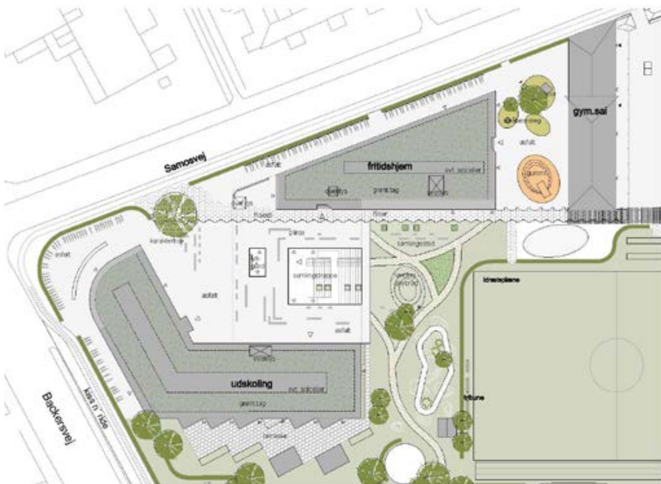
Udsnit af situationsplan, der viser placeringen af de nye byggefelter mod hjørnet Backersvej og Samsosvej og den centrale trappe. Ved Backersvej ses en planlagt 'kiss' n' ride' helle, der skal muliggøre afsætning morgen og eftermiddag. Illustration: GHB Landskab.
