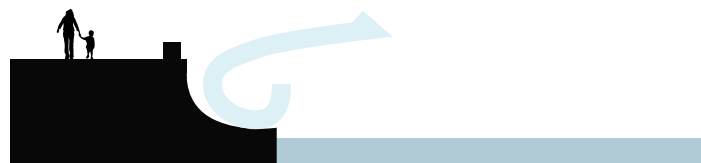
4.20 Havnekanten som vindbreaker
