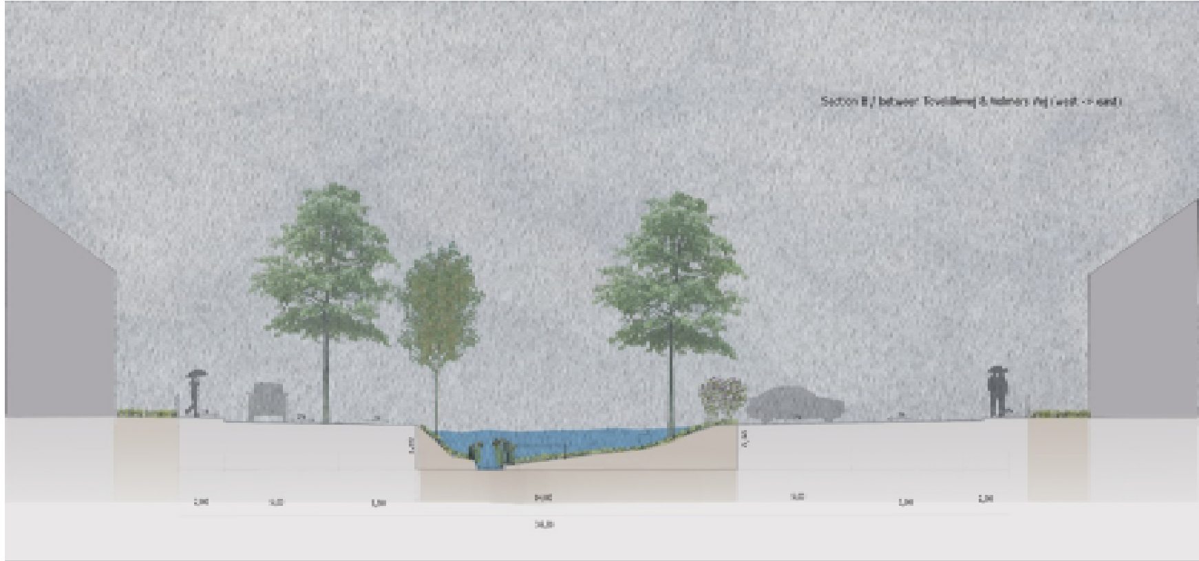
Snit for "strækning b" i skybrudssituation. Illustration: Gruppe F.
