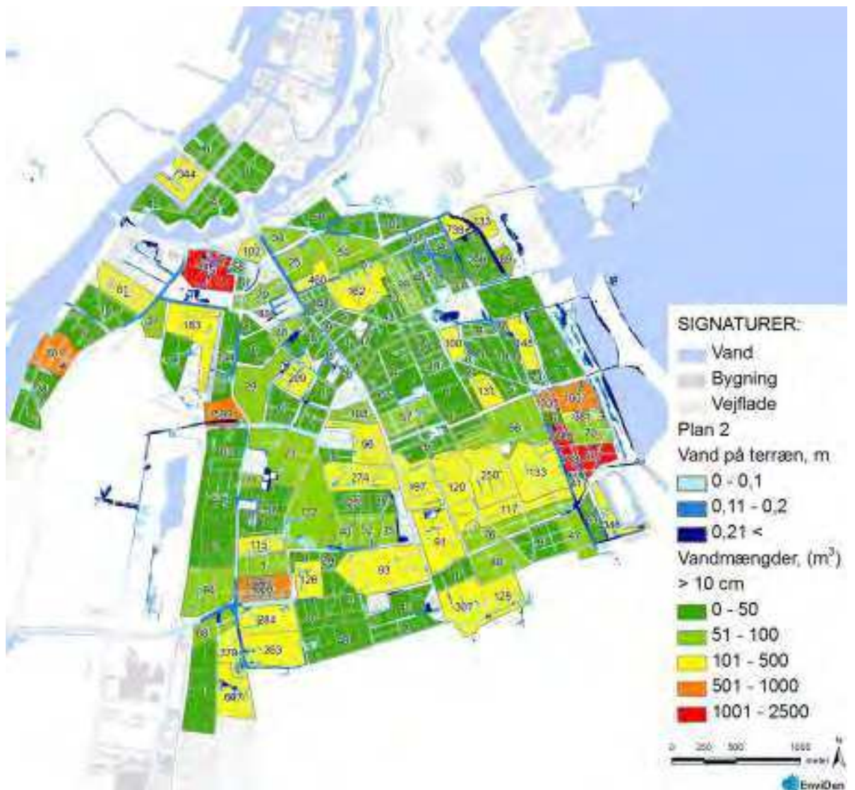
Figur 5.5: Vandmængder [m 3 ] for tertiære vandveje, planforslag 2. Mængden af oversvømmelser dybere end 10 cm efter sekundære og primære tiltag i plan 2 er implementeret. Kortbilag T04.10 kombinerer figur 5.5 og 5.6.
