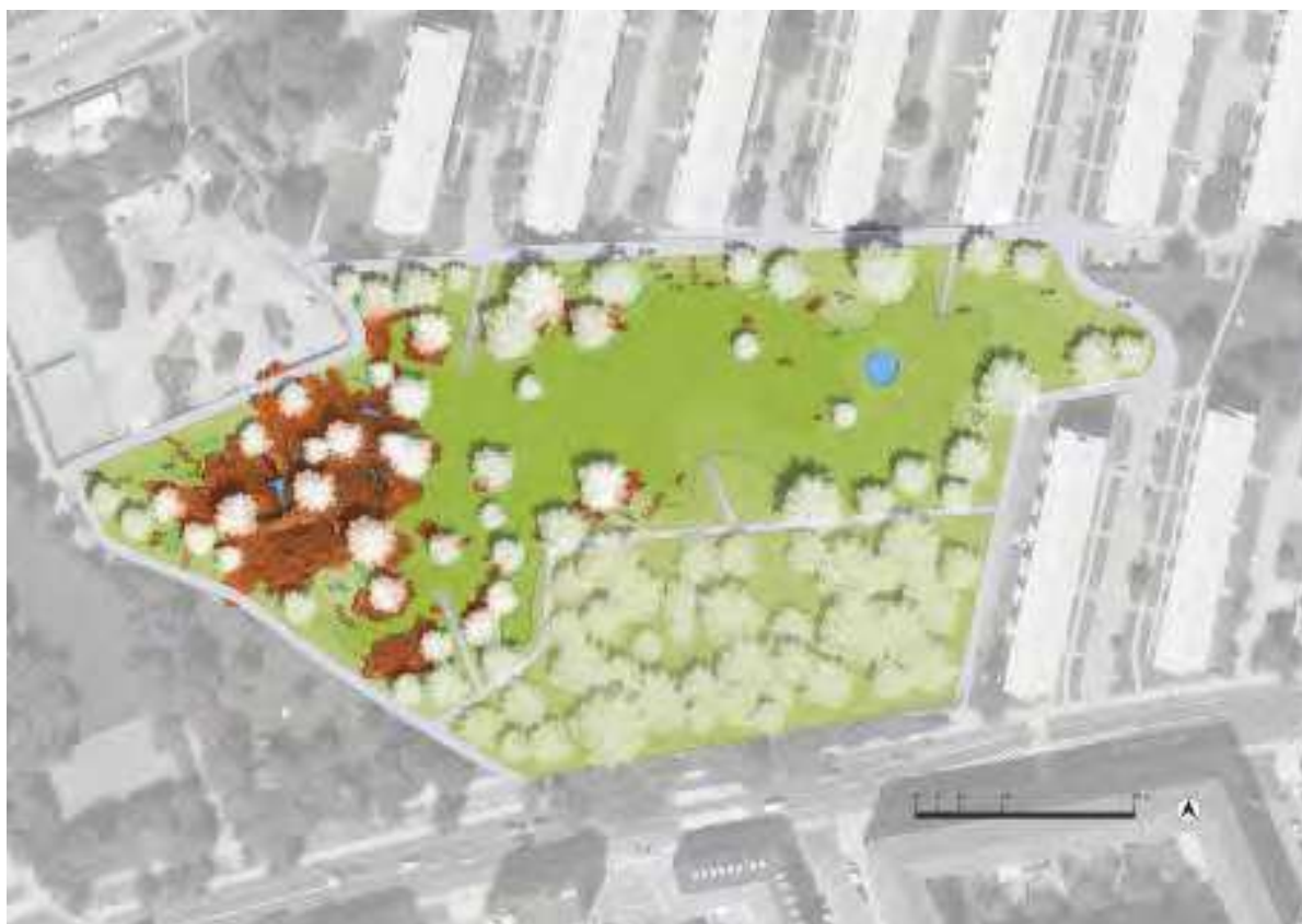
Plantegning for det foreslåede design af Lergravsparken som blå/grøn skybrudspark. Til venstre (mod vest) ses den dybe og mere betonprægede del af kløften, mens den centrale og østlige del er præget af grønt og mindre dramatiske skråninger. Maksimal vandstand ved skybrud er vist med stiplet linje. Tegning: Gruppe F.
