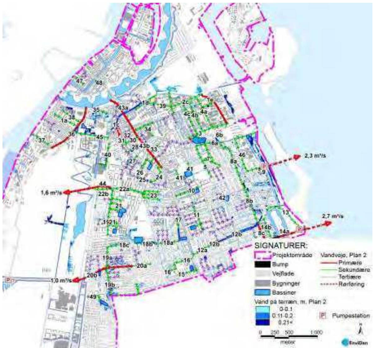
Figur 5.4: Planforslag 2 Forsinkelse. Løsninger samt simuleret maksimal vandstand på terræn ved en fremtidig 100 års regn. Kort med tiltag hhv. oversvømmelser findes i kortbilag T04.02 T04.08.
