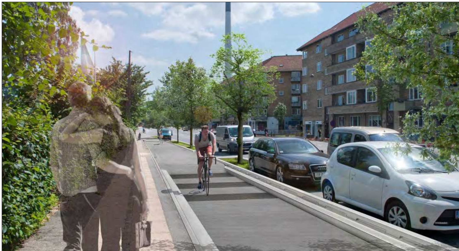
Figur 11. Visualisering af cykelsti på Tagensvej. Ved at forsænke kørebanen kan den anvendes til at opsamle skybrudsvand og bortlede det til en skybrudskanal via store riste.
