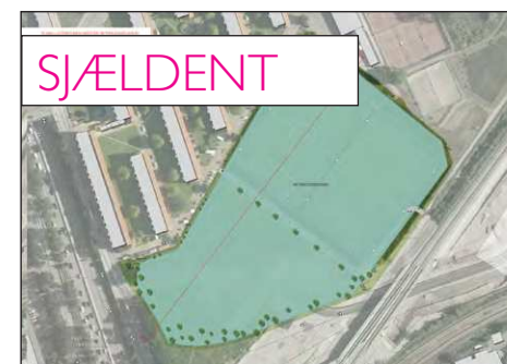
Figur 16. Ved meget kraftige skybrud kan regn- og søvand opstuves i hele Ryparken, hvor det gør mindst skade.
