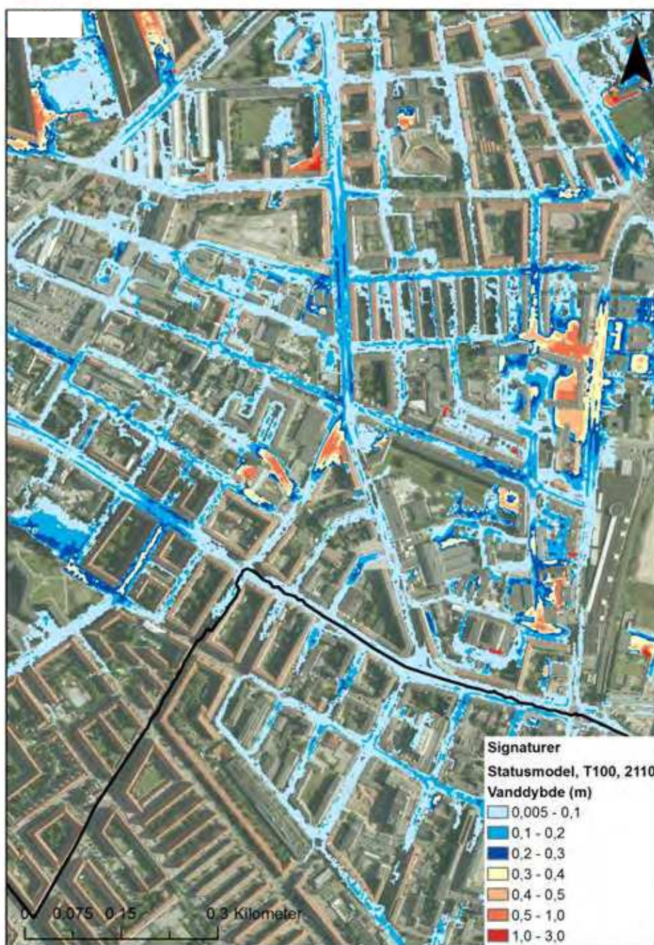
Figur 5-24 Oversvømmelser ved Lygten/Bisiddervej før tiltag for 100 års regnhændelse i 2110.
