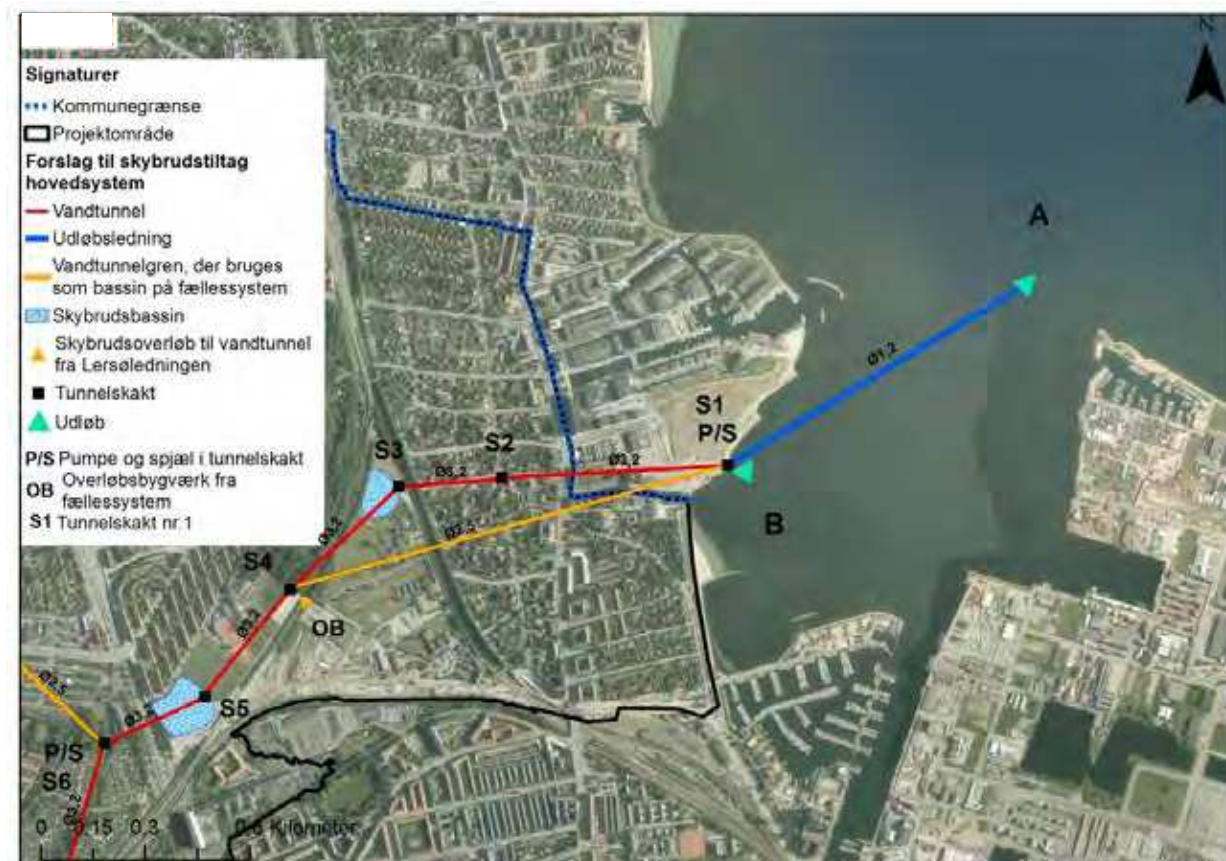
Figur 5-16 Nye Udløb A og B fra vandtunnel i Svanemøllebugten. Vandtunnelens udløbsarrangement er placeret i Gentofte Kommune på Tuborg Syd.
