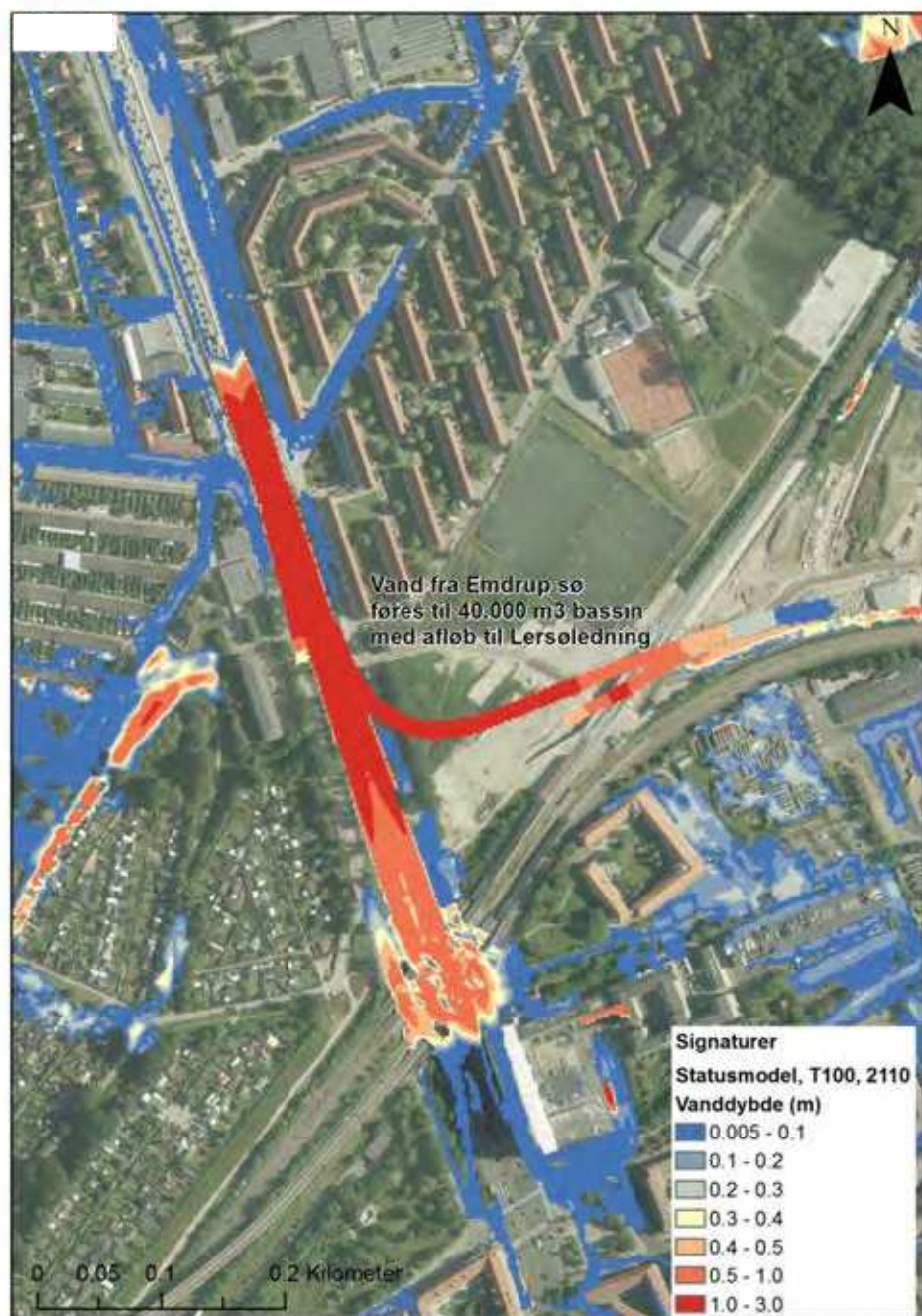
Figur 5-18 Oversvømmelser ved Lyngbyvej/Helsingørmotorvejen før tiltag for 100 års regnhændelse i 2110.
