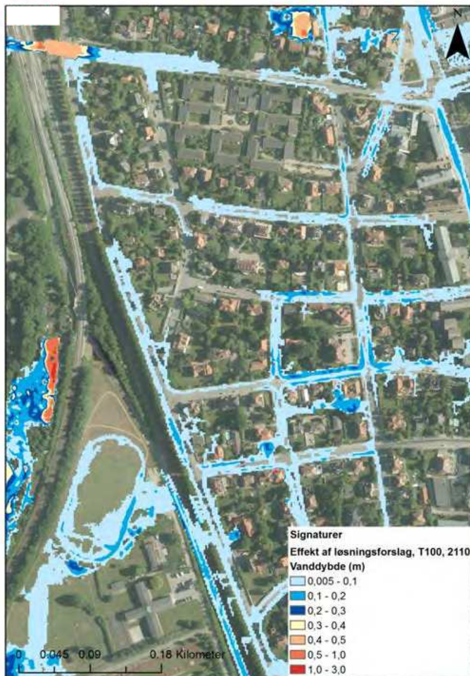
Figur 5-29 Oversvømmelser i Ryvangskvarteret efter tiltag for 100 års regnhændelse i 2110.
