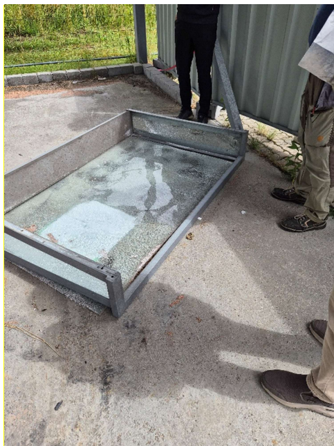
Figur 3.2 Den nedstyrtede altan fotograferet på politiets lager. Gennem glasset ses et opslag
