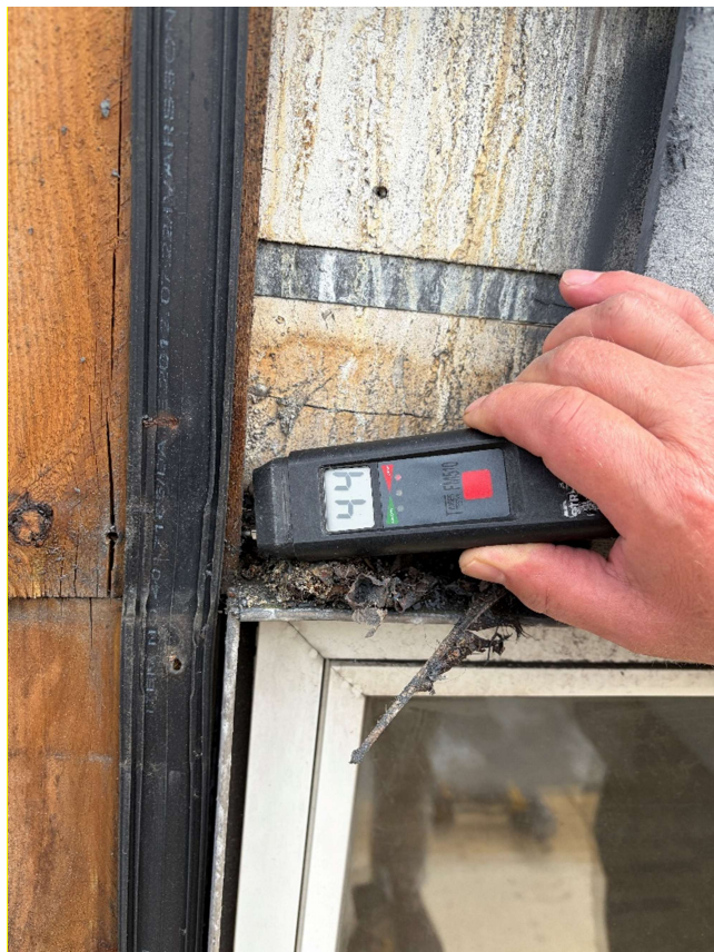
Figur 3.6 Måling af relativ fugtighed i træ omkring dørparti.
