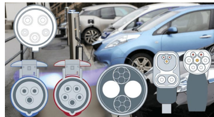
Figur 42 - Forskellige tekniske udformninger af kontakter til opladning af el-biler. Kilde: https://fdel.dk/guides/ladning/guide-til-ladning/
