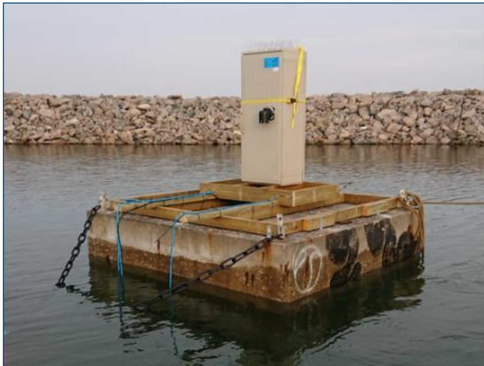
Figur C-2 Målestation for nitrat og salinitet, opankret i Bassin B. Nitratsensoren er horisontalt monteret via de to blå liner.
