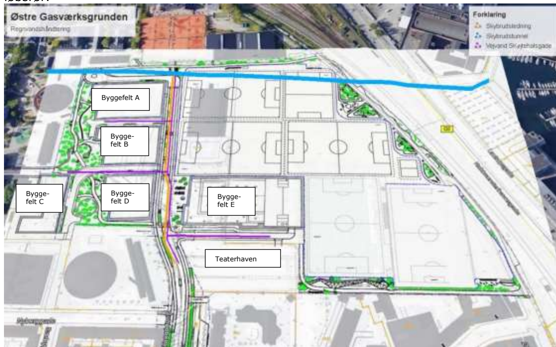
Figur 5 Skitsering af ledninger til håndtering af regnvand i projektområdet. Orange er skybrudsledning og lilla er vejvandsledning med rensning inden tilslutning til skybrudsledning.
