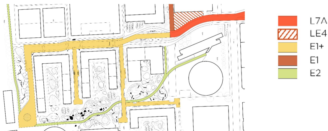
Figur 15 Krav til belysningsklasser i området (simplificeret oversigtstegning)
