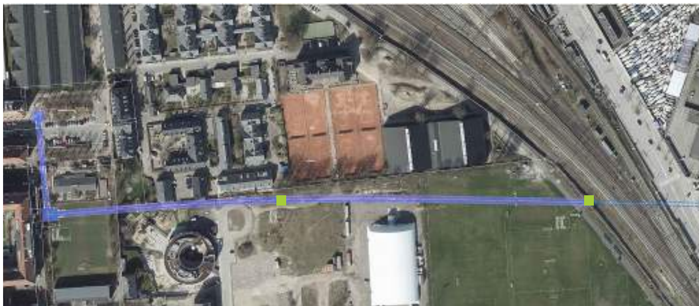
Kortet viser placering af skybrudsledning. De to brønde er markeret med grøn firkant.
