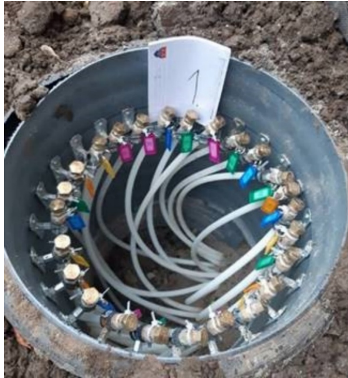
Figur 14 Eksempel på etablering af slangerne fra målepunkterne i brønd.
