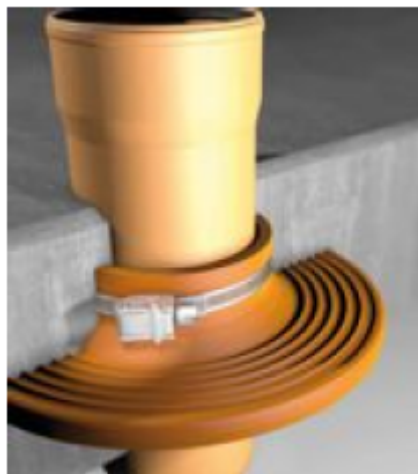
Figur 17 Gummiflange til tætning af rørgennemføringer. Montering på rør inden der fuldstøbes rundt om rørene.
