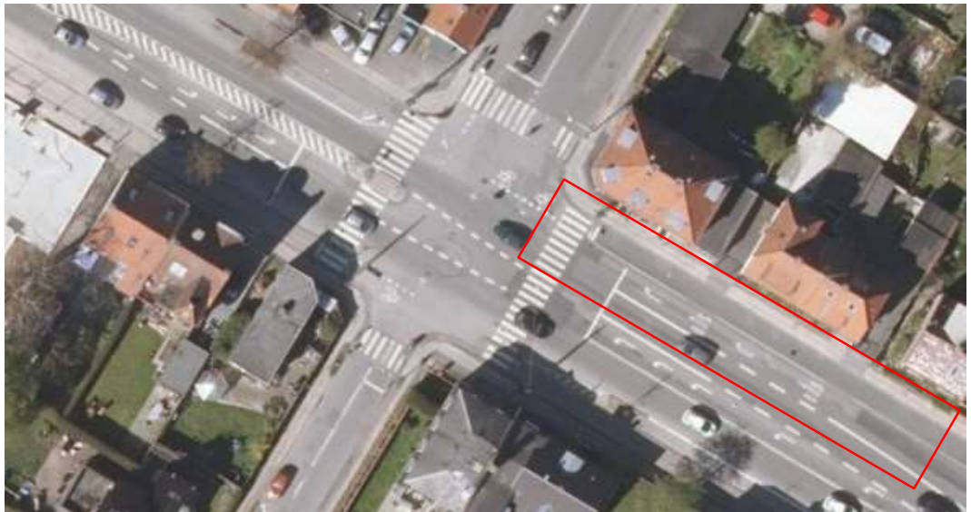
Figur 6. Eksempel på en krydsombygning (i dette tilfælde ét kryds-/signalben) fra afkortet cykelsti til fremført cykelsti og separat højresvingbane med tilladt ligeudkørsel for busser.
