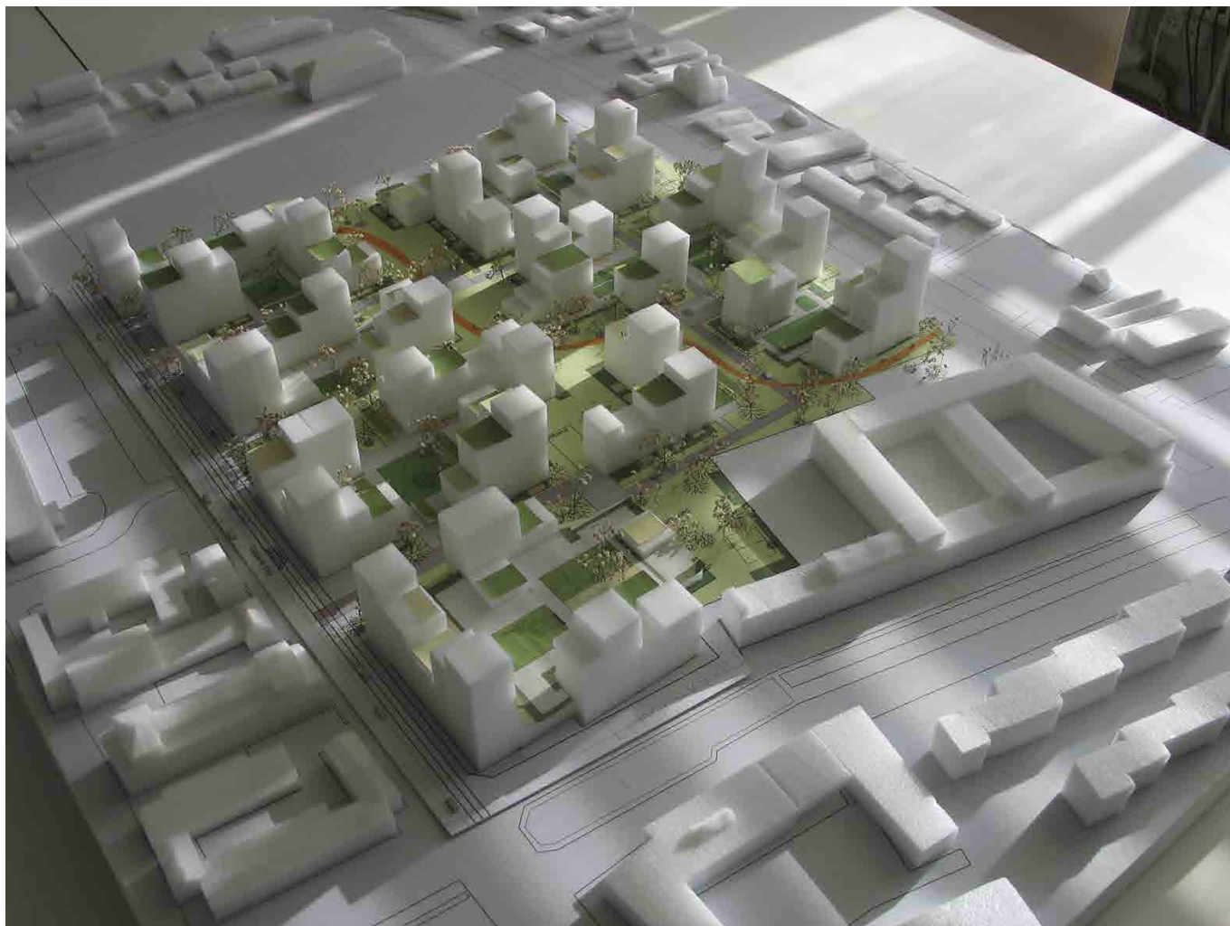
Model af principbebyggelsesplan for område II. Bebyggelsen fremstår som en komposition af sammensatte bygningsenheder på et græstæppe placeret under hensyn til lys/skygge vind/læ, så der dannes forskellige rum og rumforløb. Hver enhed består af et profil med store skalaskift. Tage og tagterrasser begrønnes på nær de øverste tage i hver enhed, som afsluttes med en skrå eller flad tagflade.
