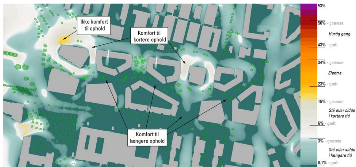
Illustration 8.7.1: Vindkomfortanalyse, der viser hvor ofte det blæser mere end 6 m/s vægtes for alle vindretninger
