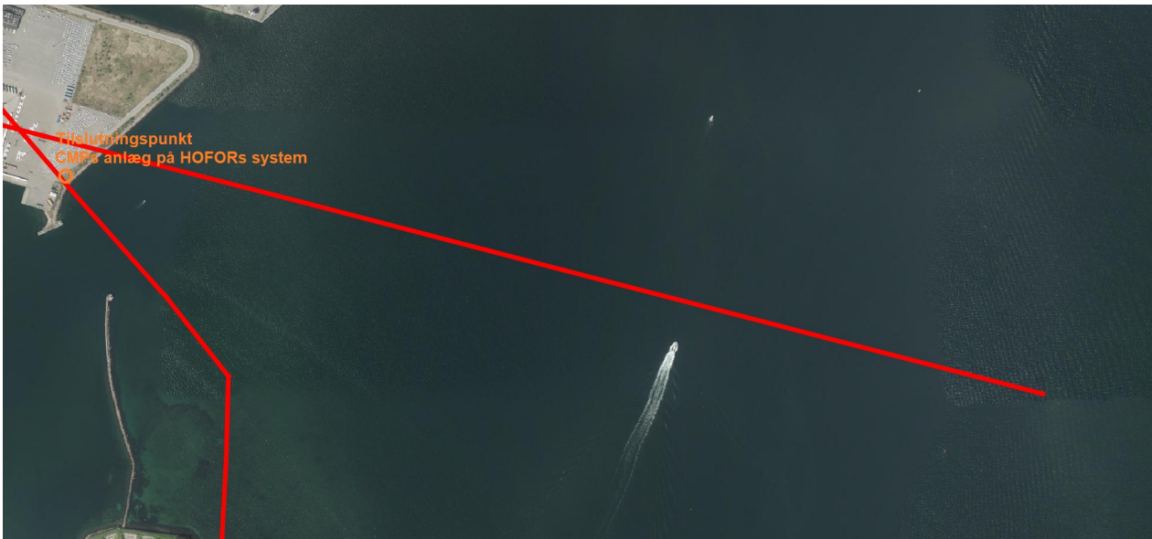
Figur 2. Tilslutning af havforsyningsledninger til CMP's anlæg, og af CMP's anlæg på HOFORs system. Klik på billedet for at forstørre.
