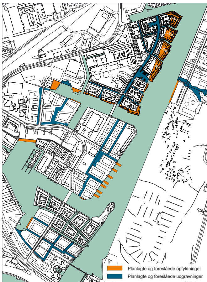
Opfyld og udgravning i Sydhavnen. På Enghave Brygge afgraves ca. 30.000 m 2 og opfyldes ca. 35.000 m 2 . Bebyggelsesplanen er ikke opdateret.
