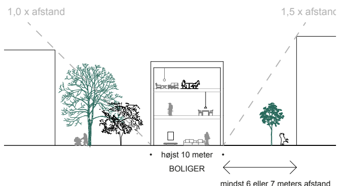
Fig. 1. Principsnit højdegrænseplan. Entasis
