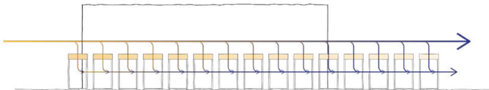
Energioptagere henter varme ud af luften
