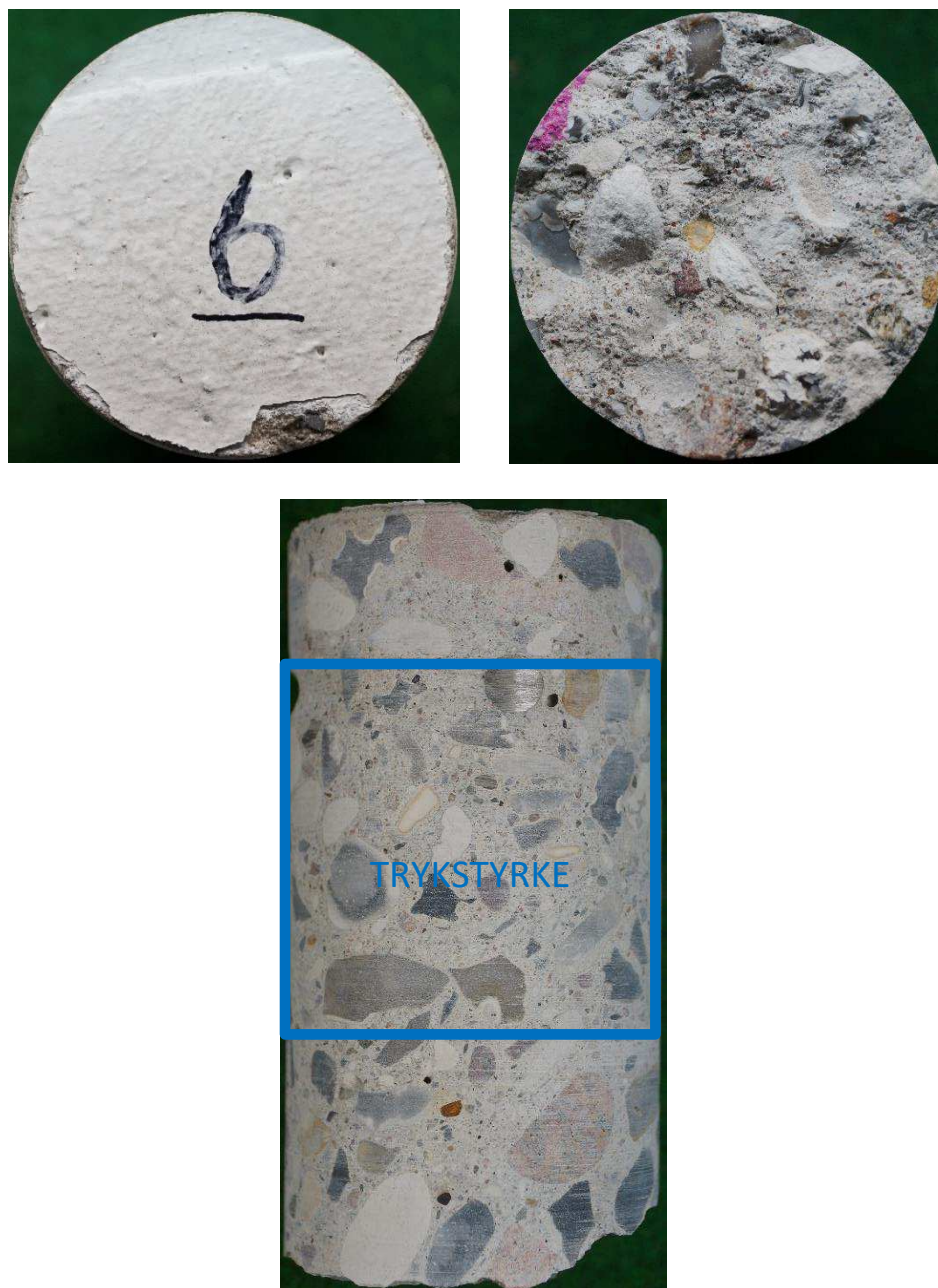
Fig. 6. Kerne 6, boret vandret ind i endevæg set fra den eksponerede overflade (øverst venstre) og brudfladen (øverst højre) og set fra siden med kernes eksponerede overflade opad.
