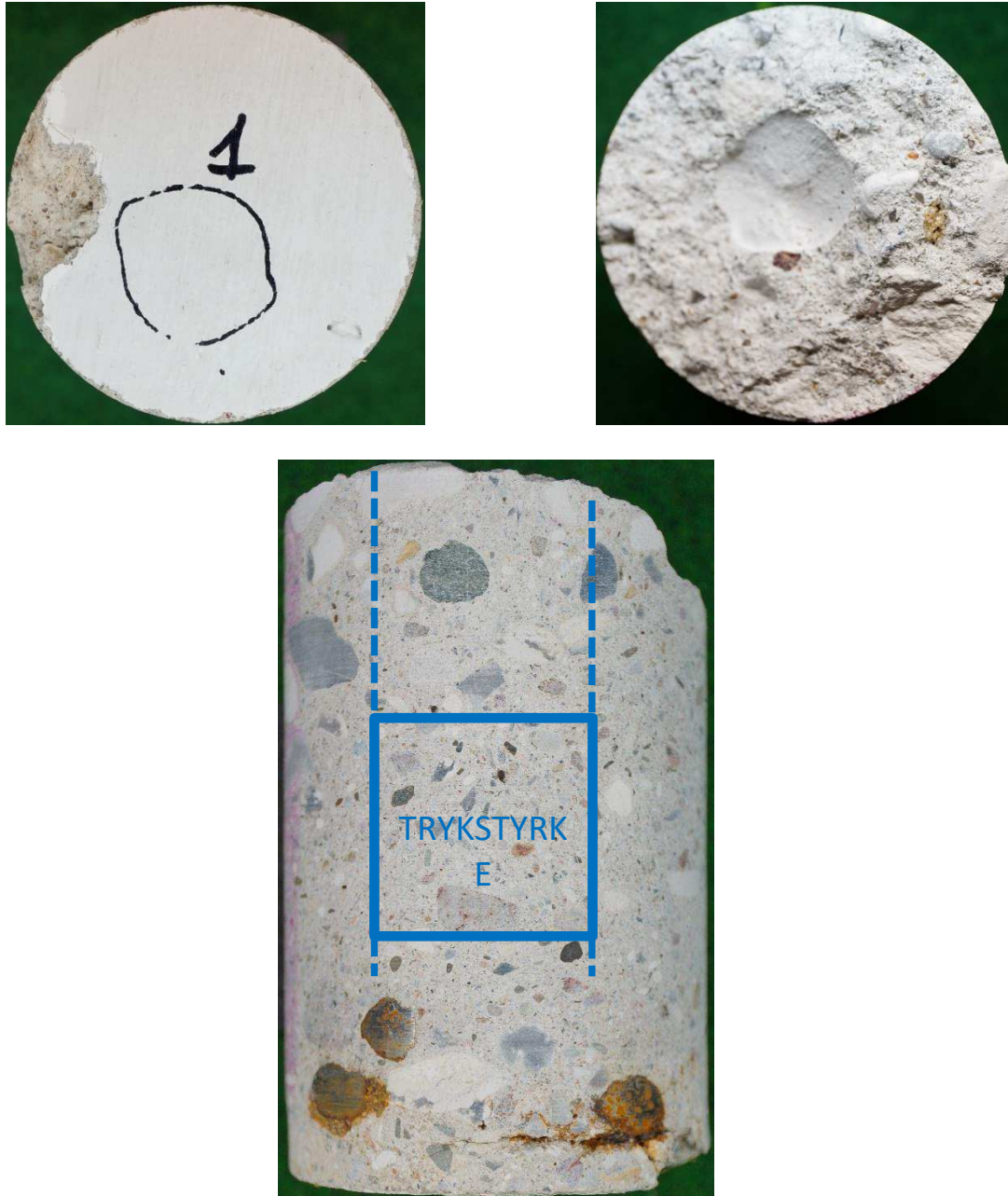
Fig. 1. Kerne 1, boret under-op i dækket, set fra den eksponerede nedre overflade (øverst venstre) og brudfladen (øverst højre), samt set fra siden, hvor kernen er orienteret retvendt.
