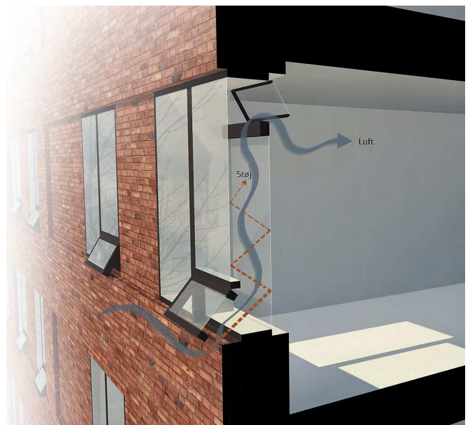
Vinduerne mod støjkilden indrettes, så der kan udluftes, uden at støjen følger med som vist på visualiseringen. Ill. af Arkitema.
