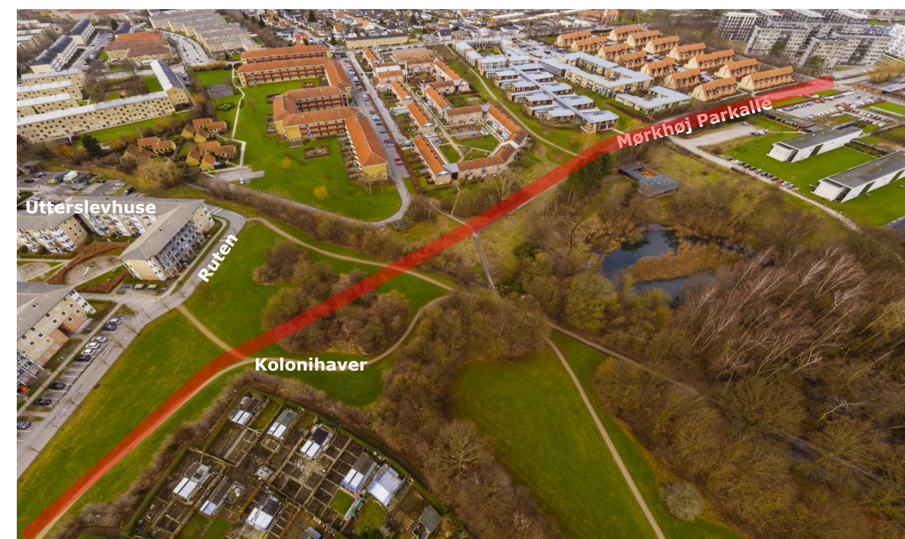
Figur 5. Oversigtsbillede over eksisterende stiforbindelser i projektområdet. Linjeføringen for den nye vejforbindelse er angivet i rødt.
