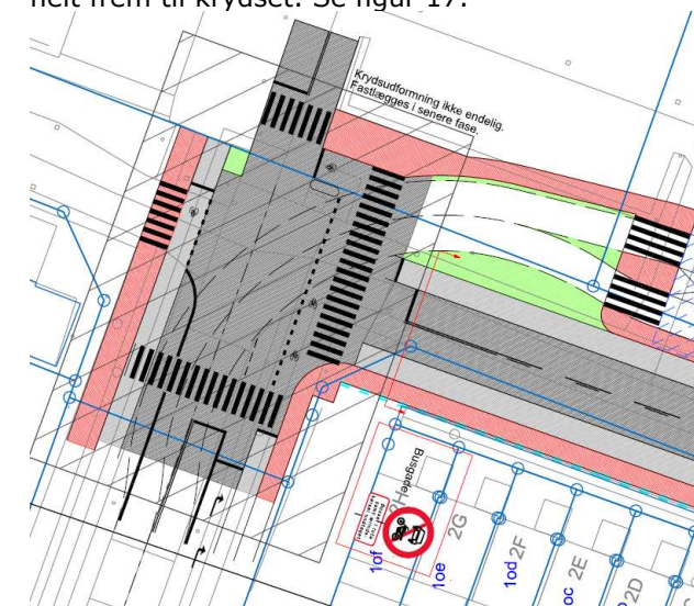
Figur 16. Forslag til udformning af krydset Vejforbindelse A/Mørkhøj Parkallé. Udsnit fra tegningen 348 16.
