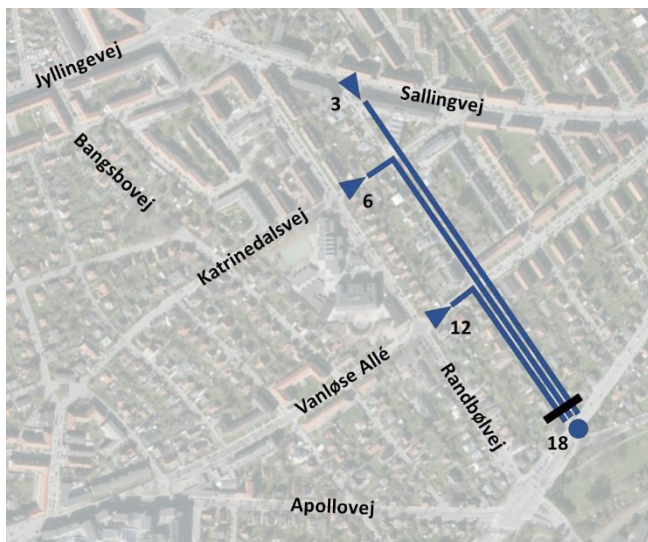
Figur 5: Rutebundter for gennemkørende trafik via Ådalsvej på delstrækningen mellem Vanløse Allé og Rebildvej mod syd.
