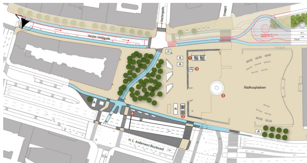
Figur 2. Planlagt byrum ved Rådhuspladsen med tilhørende ændringer jf. Scenarie 1 med vendeplads til busser uden bakning. Se Bilag 2.
