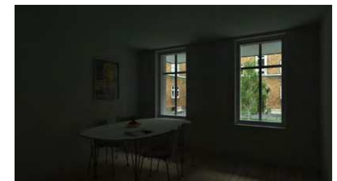
Lyset på en gråvejrsgang med en altan på 1,5 m over begge vinduer
