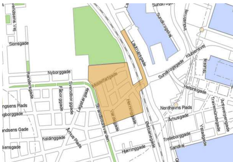
Figur 12 Skybrudsopland til Kalkbrænderihavnsgade som tilsluttes Østerbro-ledningen.
