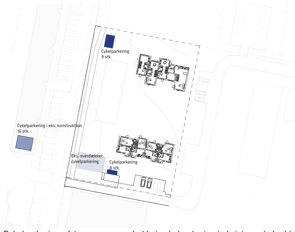
Cykelparkering på terræn og overdækket cykelparkering i eksisterende kældre
