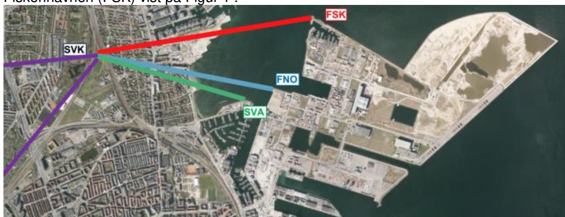
Figur 1 De undersøgte placeringer af udløbsbygværket ved Svaneknoppen (SVA), Færgeshavn Nord (FNO) og Fiskerihavnen (FSK) og forløbet fra nærmeste skakt ved Svanemøllen Kaserne (SVK).
