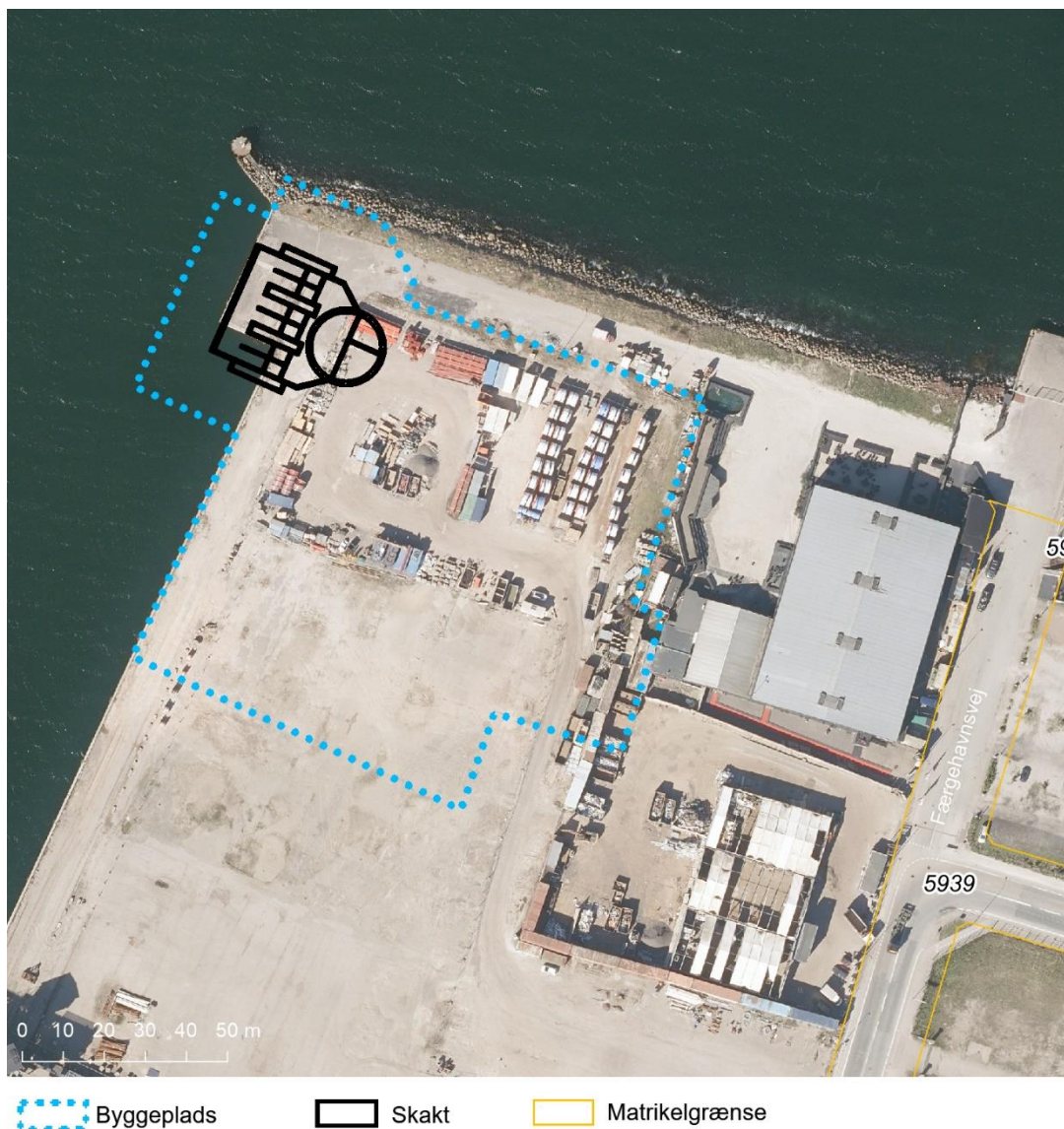
Figur 4 Afgrænsning af byggeplads ved Færgen Nord. Byggepladsen vil kræve en opfyldning i Kalkbrænderiløbet. Arealet vil være inddraget til byggeplads i ca. 5 år.
