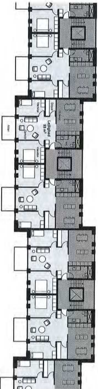
Eksemplet på indretning af lejligheder, hvor trapperne, wc og køkken placeres mod nord.
