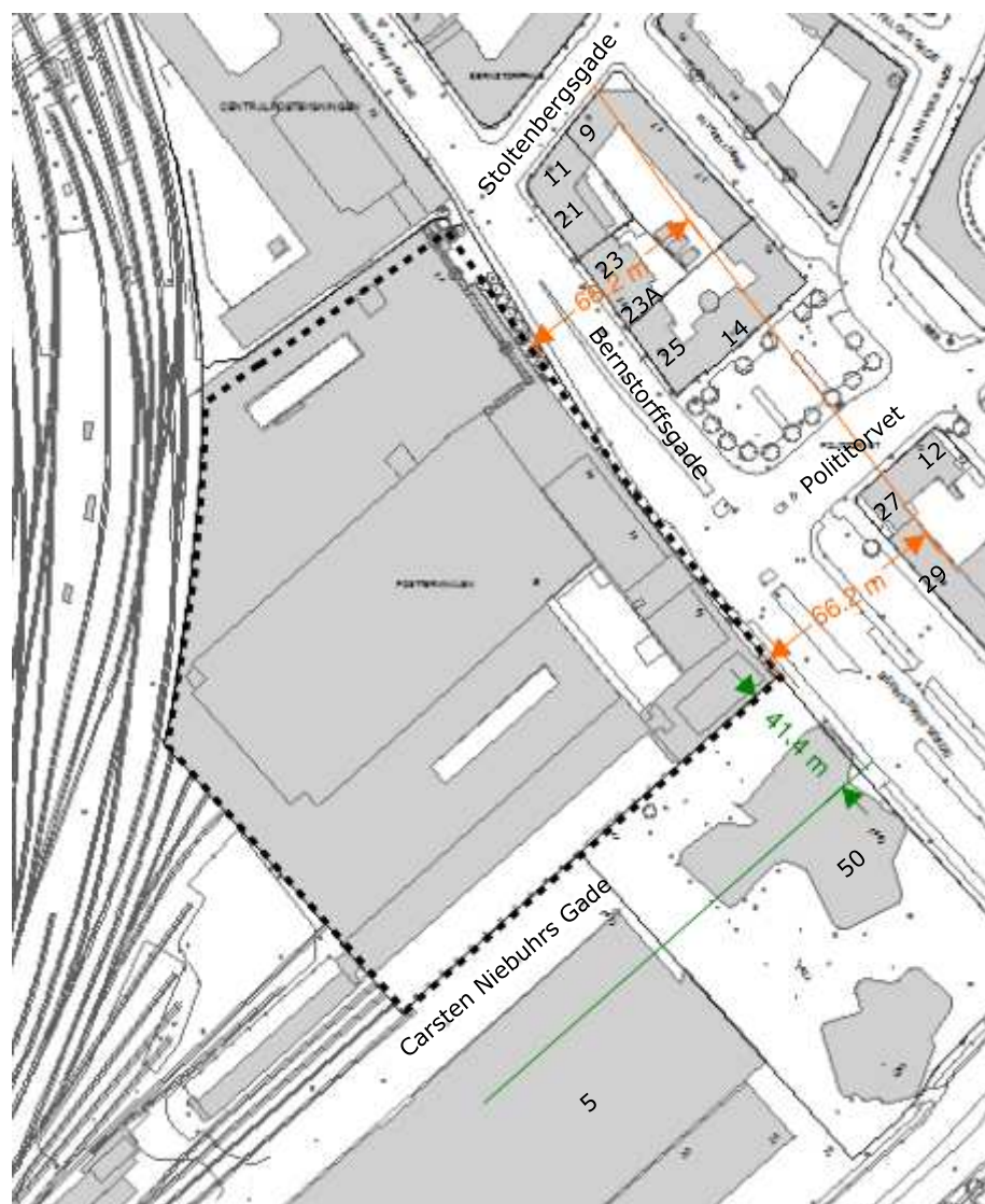
Figur 9-5 Vibrationskomfort for rammet spuns. Orange linje er den kritiske afstand for blandet bolig og erhverv. Den grønne linje er den kritiske afstand for erhverv byggeri.
