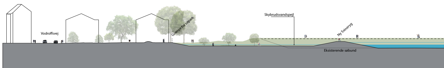
↑ Snit af sydlig sø – fremtidige forhold. I både den sydlige og nordlige sø indskrænkes vandfladen, Svineryggen bortgraves og der etableres en ny Svineryg ude i søen længere mod øst. Endvidere udgraves en ny søpark.
