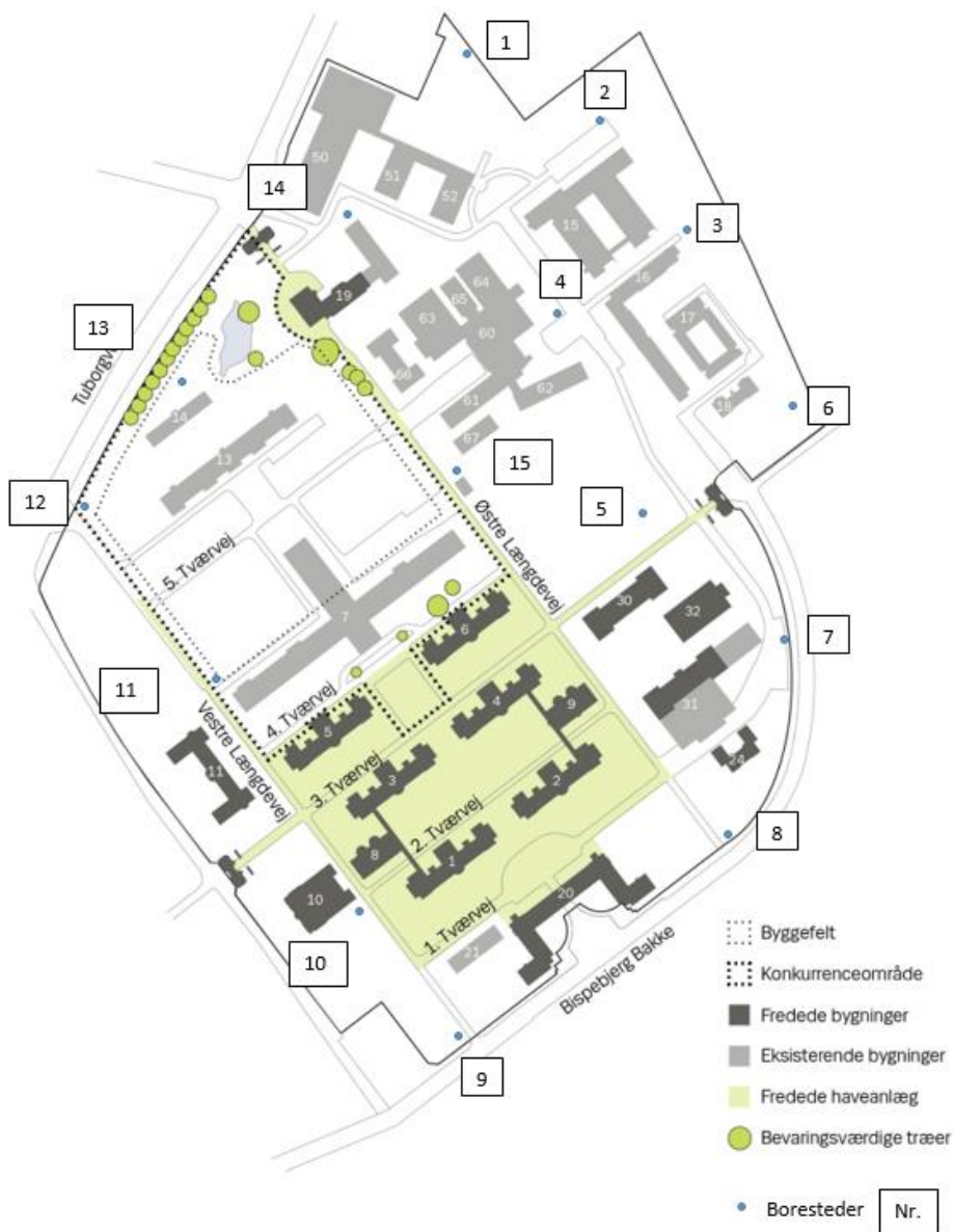
Figur 6. Bispebjerg Hospital. Udpegede boresteder for op til 15 boringer. 12 boringer vurderes tilstrækkeligt for projektet. Boring 5 og 7 er etableret i forbindelse med forundersøgelsen.
