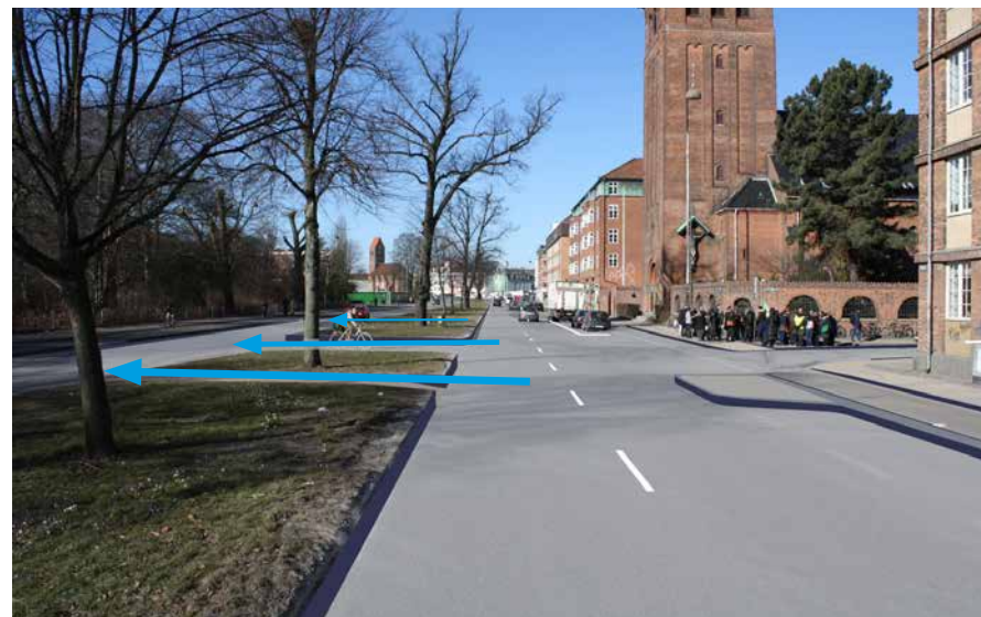
Figur 7e. Figuren viser, at kørebanens sænkes 20 - 30 cm, hvor vandet samles. Herfra ledes det videre til Fælledparken. De blå pile viser vandets afledningsretning fra Jagtvej til Fælledparken.
