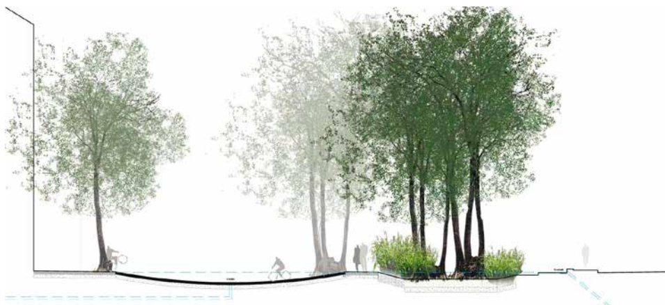
Figur 9. Figuren viser et snit gennem parkstrøget på Strandboulevarden med forslag til, hvordan hverdagsregn kan anvendes rekreativt i en hverdagsituation..
