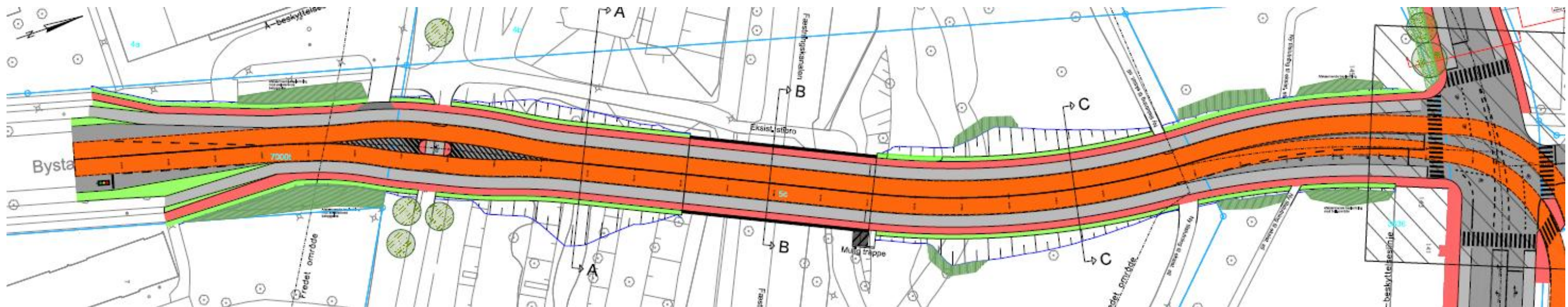
Figur 13. Forslag til linjeføring mellem Bystævnet og Ruten. Kørebane vist med orange er fælles for letbane og motor-køretøjer. Udsnit af tegningen 353 16 jf. bilag.
