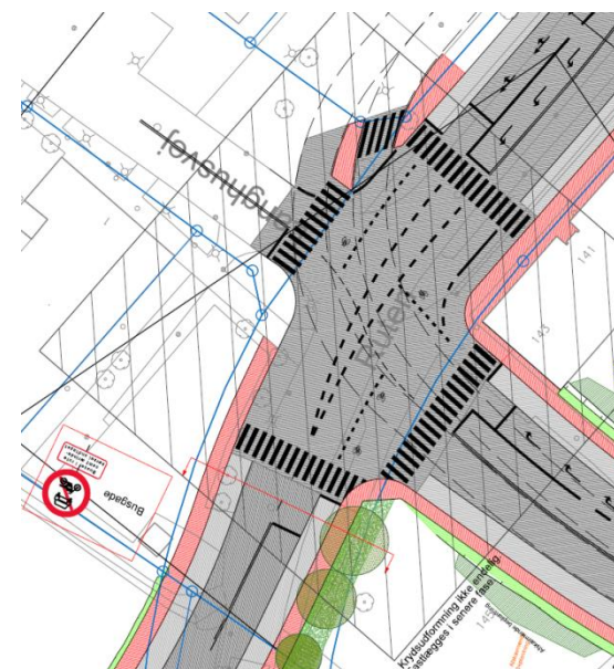
Figur 15. Forslag til udformning af krydset Ruten/Langhusvej/Vejforbindelse A/Vejforbindelse B. Udsnit fra tegningen 348 16.
