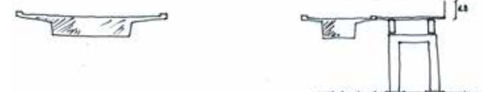
Tværsnit, eksisterende betonvejbro vist til venstre og betonstibro mod nord til højre og ny cykelbro på nordsiden heraf (her blot vist som grov skitse).
