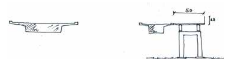
Tværsnit, eksisterende betonvejbro vist til venstre og betonstibro mod nord til højre og ny cykelbro på nordsiden heraf.
