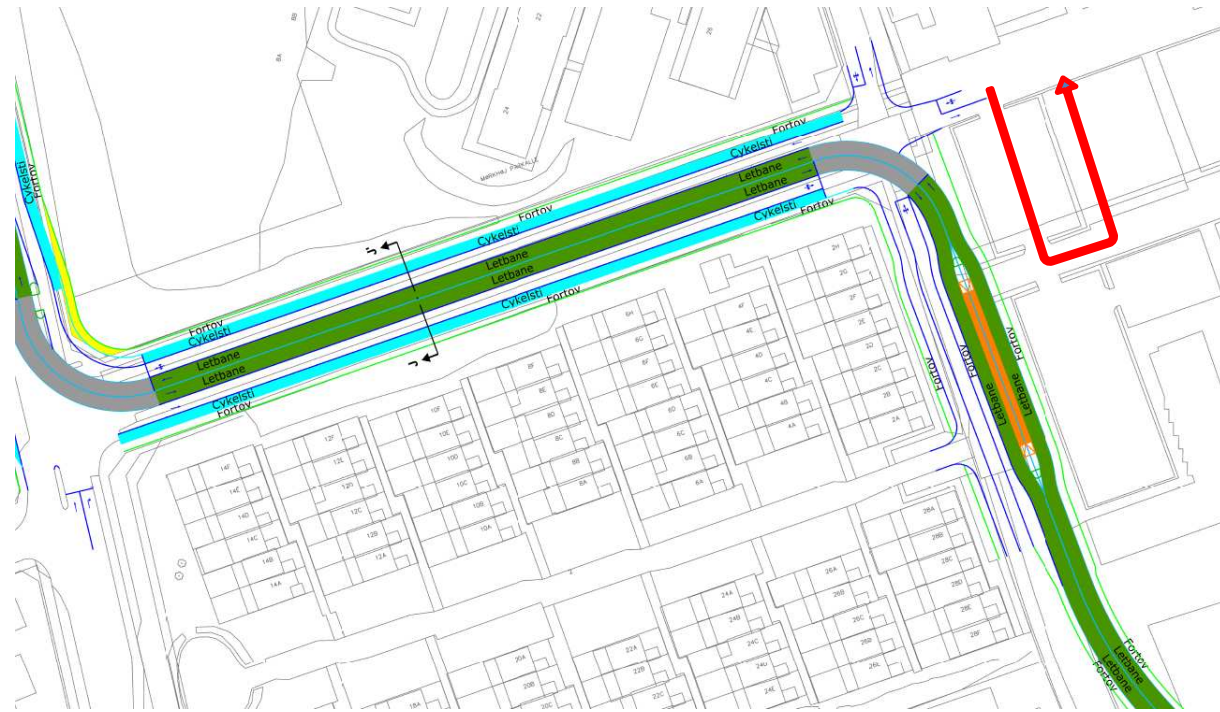
Figur 18. Skitseforslag for Letbanens vejforbindelse langs Mørkhøj Parkallé (COWI). Forslag til en ensrettet vej på bagsiden af p-pladserne, så der kan skabes et ensrettet cirkulært flow
