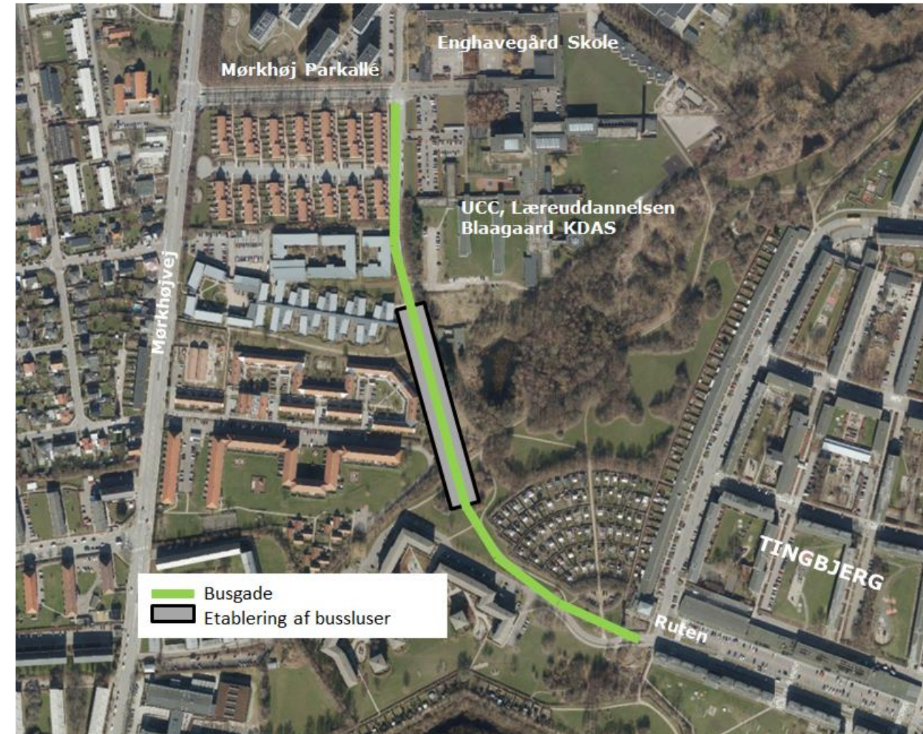
Figur 12. Illustration over busgade og placering af busluser.
