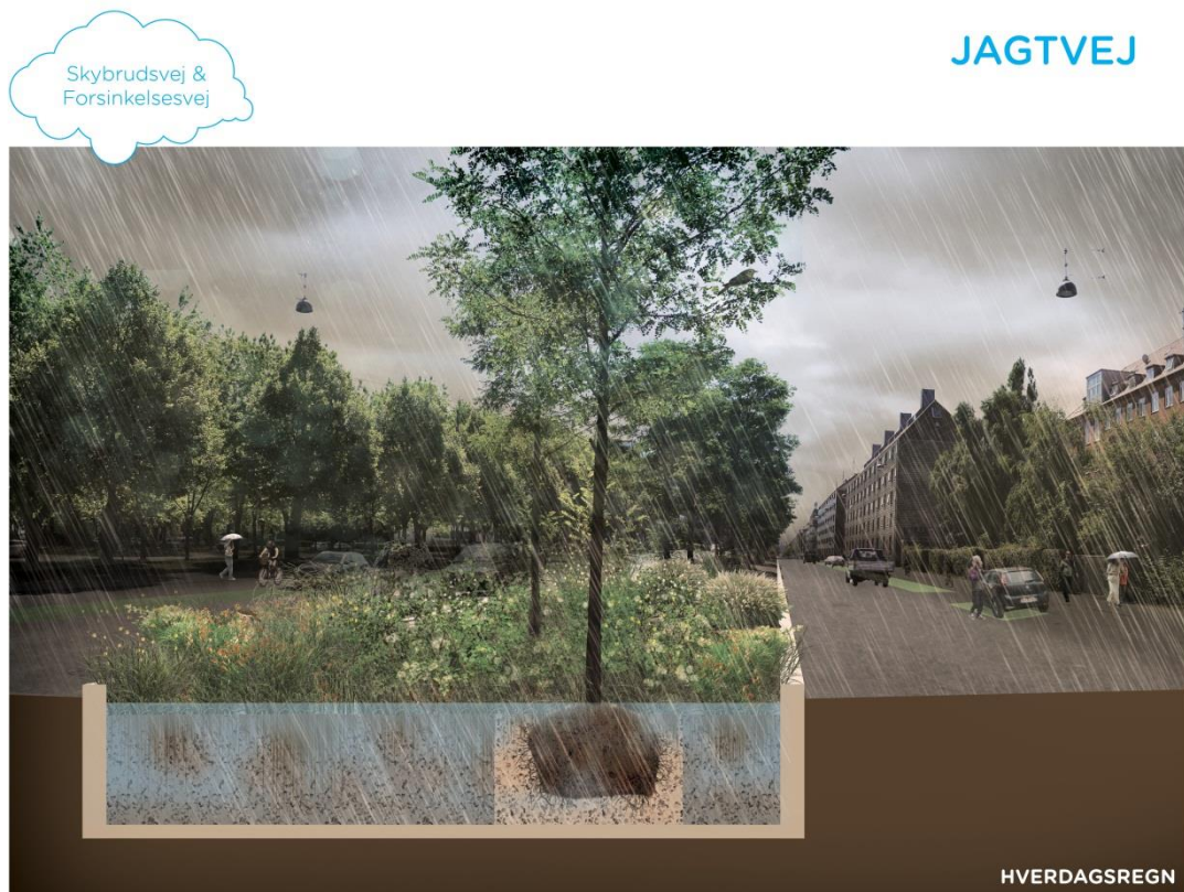
Figur 18 Skybrudsvej med grønne render og forsinkelsesvolumen til regnvand fra tage og fortove, – eksempel fra Jagtvej. Se bilag 0.3-212
