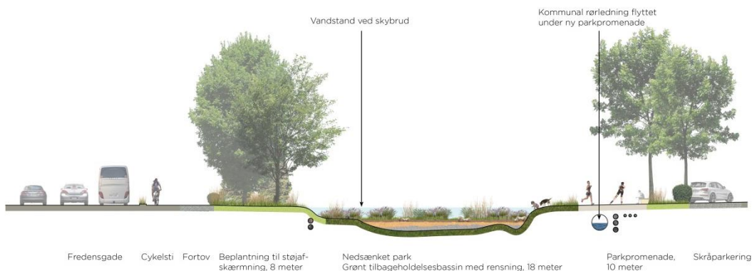
Figur 19: Central forsinkelse i Fredens Park – en del af parken omdannes til rensende regnbed så hverdagsregn kan anvendes til vandlegeplads, mens større dele af parken udføres med sænkede arealer, der kun fyldes ved skybrud. Se bilag 0.3-304/305
