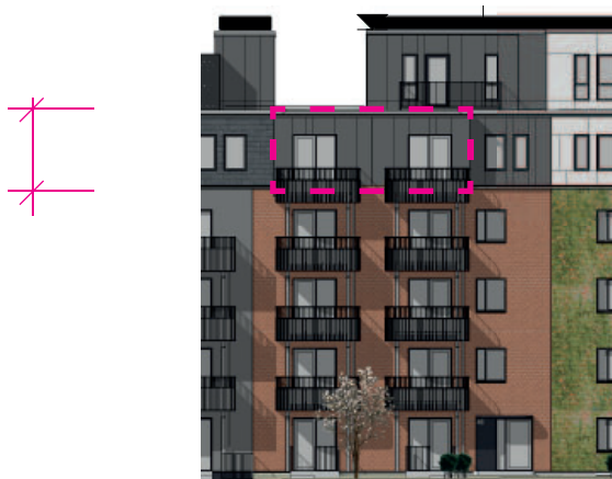
Facadeudsnit og snit. Eksempel på udgang til to altaner på 4. sal, gadeside
