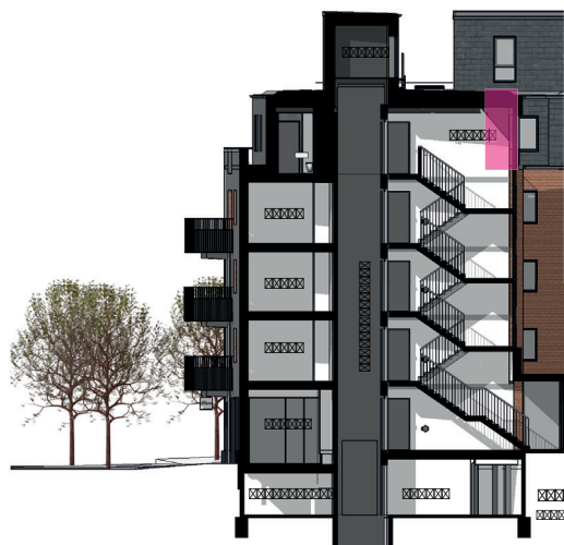
Snit og facadeudsnit. Eksempel på fremskudt trapperum på 4. sal, gårdside
